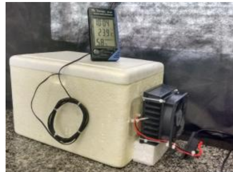
FIGURA 2 – FOTO DO TROCADOR DE CALOR. FONTE: UNIVESP (2016).
